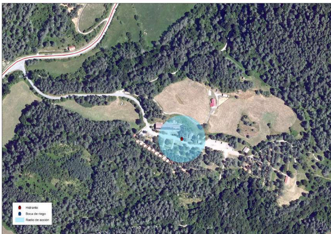
Camping Asolaze: superficie cubierta por hidrantes y bocas de riego
